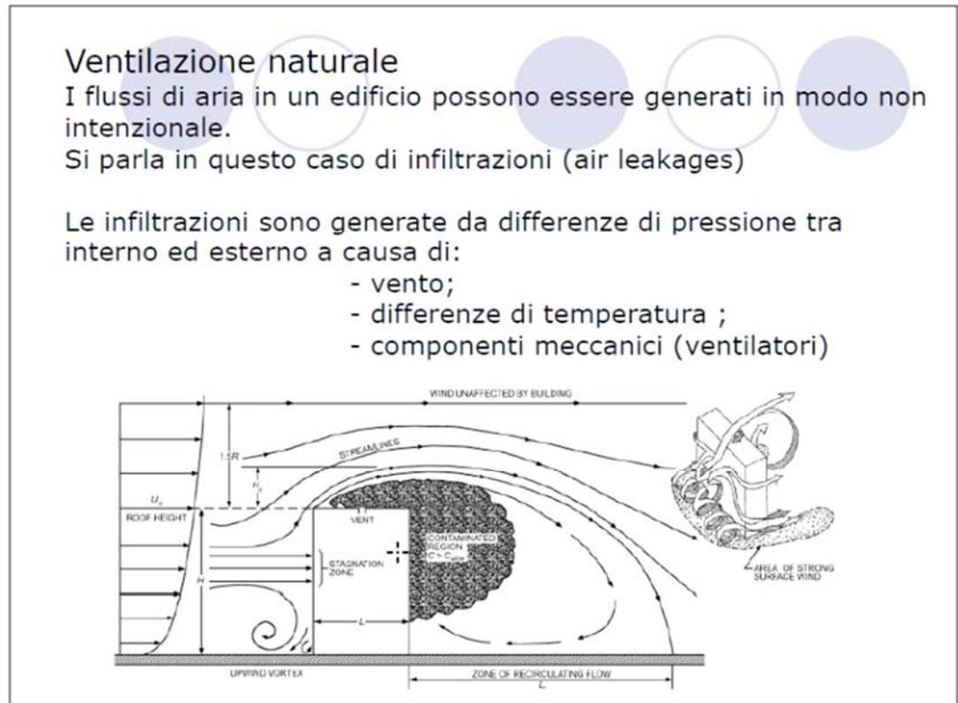
Il vento che spinge sull'edificio crea differenze di pressione che infiltrandosi nei serramenti producono ricambio d'aria naturale.
