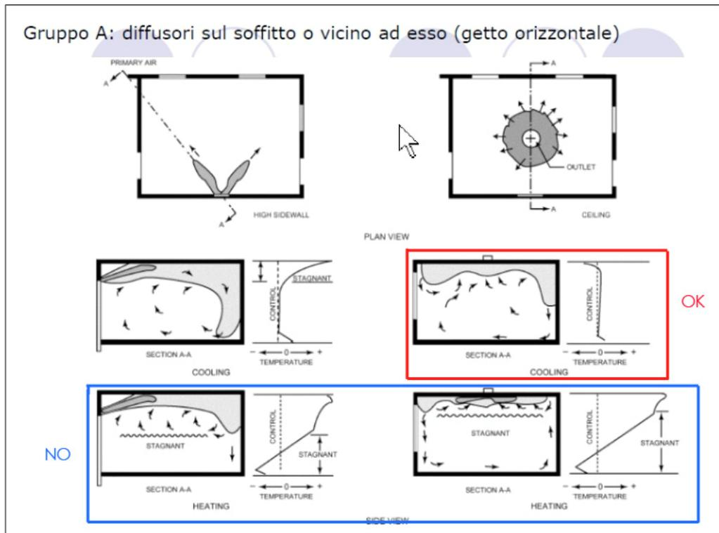
Quando il sistema di ventilazione funziona, l'aria circola e la distribuzione di temperatura è quasi uniforme.
