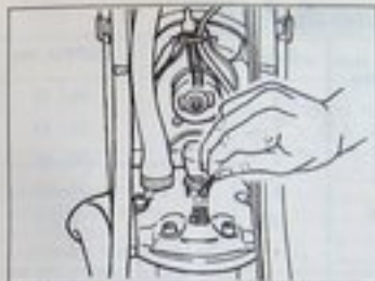
Fig. 39 - Verifica funzionamento elettroventola
