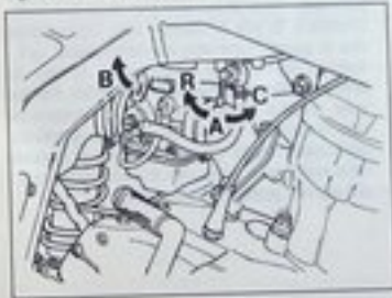
Fig. 5- Rubinetto benzina A = aperto C = chiuso R = riserva
