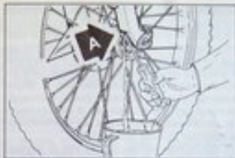
Fig. 19 - Viti scarico olio
