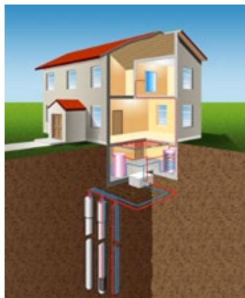
Pompe di calore a terreno con sonde orizzontali e verticali
