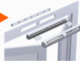
Montaggio ingresso aria nell'infisso
