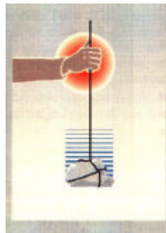
Figura 4: Mentre il sasso scende, le dita tra cui scorre la corda si scaldano leggermente. Questo aumento di temperatura è legato a una maggiore velocità con cui si muovono le molecole della pelle delle dita (e anche della corda). Ciò significa che l'energia interna delle dita e della corda è aumentata a spese della diminuzione dell'energia potenziale del sasso. Nel complesso l'energia totale del sistema si conserva.
