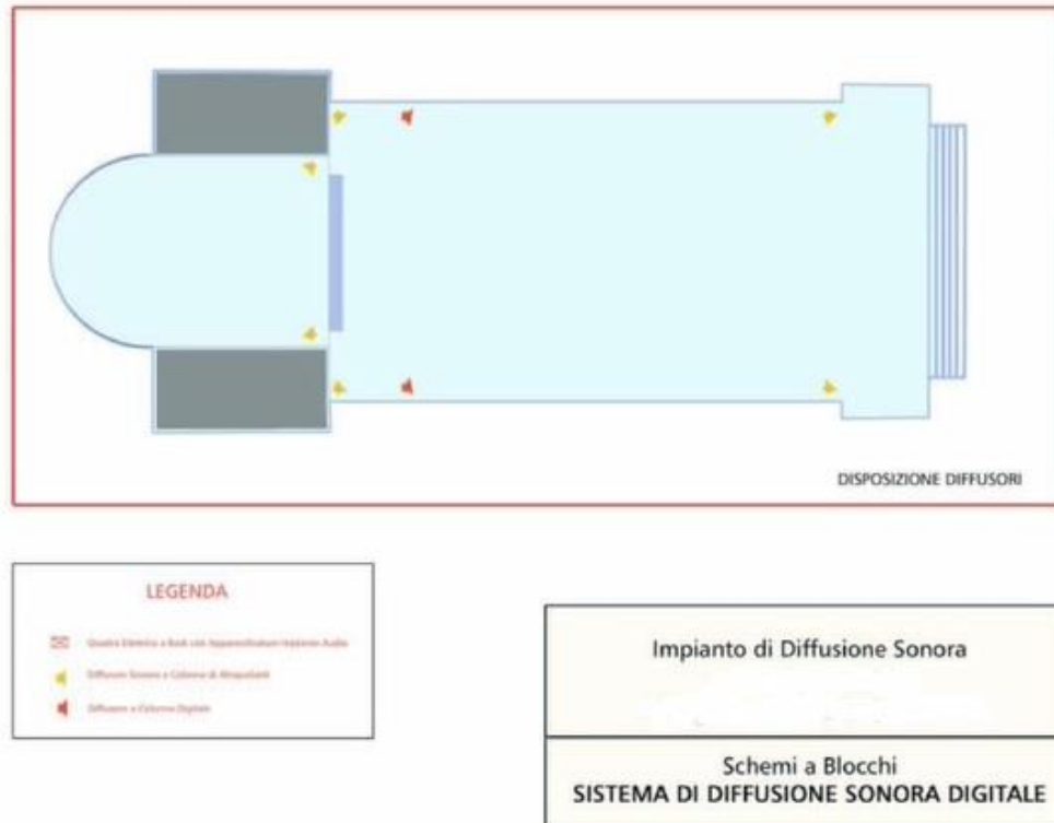
Immagine 1 - Corretta posizione dell'impianto di diffusione sonora nel caso di una chiesa.
